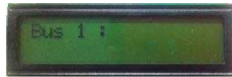
Gambar 3.14 tampilan LCD karakter sebelum mendapatkan data dari web server
