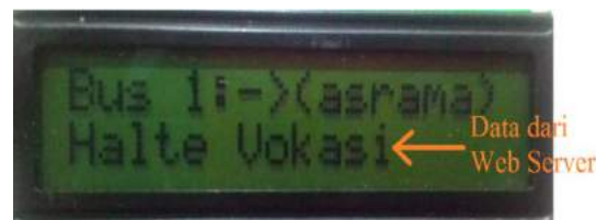
Gambar 3.15 Tampilan LCD setelah mendapatkan data dari web server.
